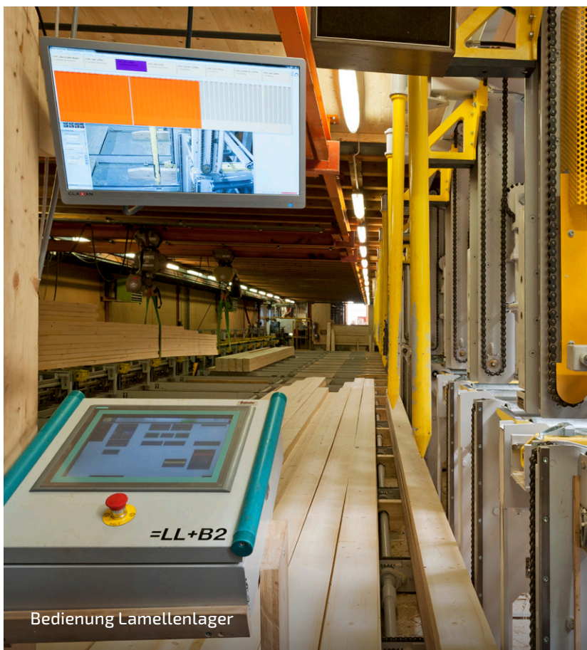
Vollautomatischer Lamelleneinzug zur Flächenbelegung
